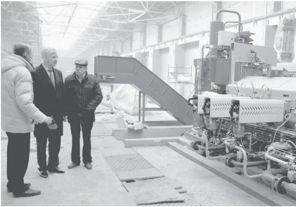
Гидравлический пресс «GiA Clesim» (Испания) усилием 1800 тонн
